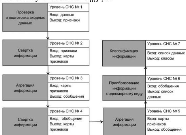
Рисунок 10 – Вариант архитектуры нейронной сети для моделирования ТО газосигнализаторов
